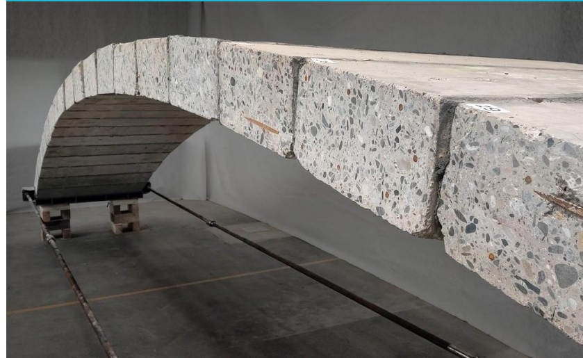
Brug uit hergebruikte betonblokken
