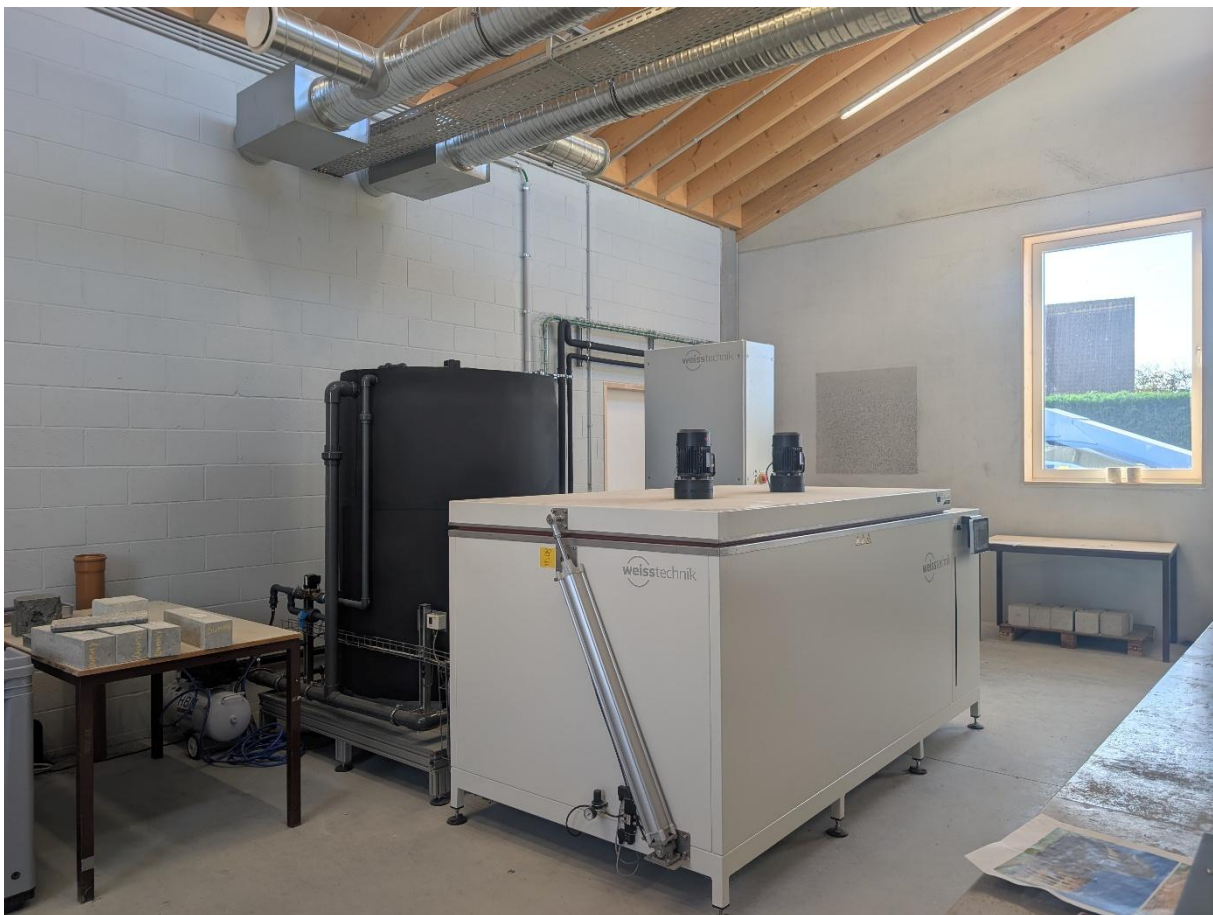
KLIMAATKAST INTERNE VORSTSCHADE. WEISS TECHNIK BOUWSTOFTESTER BT1000, IN HET CIRCULAR CONCRETE LAB CCL)
