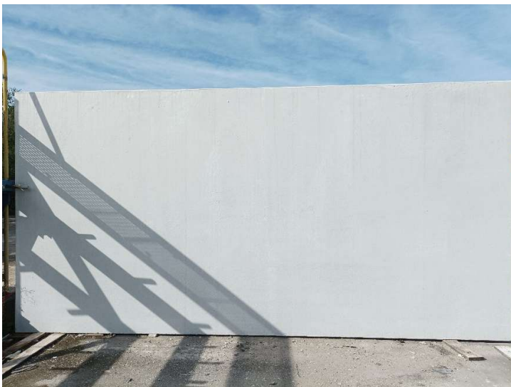
Figuur 2: Prefab betonpaneel, geproduceerd met 50% vervanging van de grove granulaatfractie door gecarbonateerd betongranulaat (CRH).
