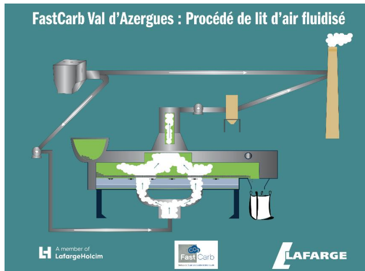
Figuur 4: Pilotproject carbonatatie van betongranulaten bij FastCarb schematisch weergegeven.
