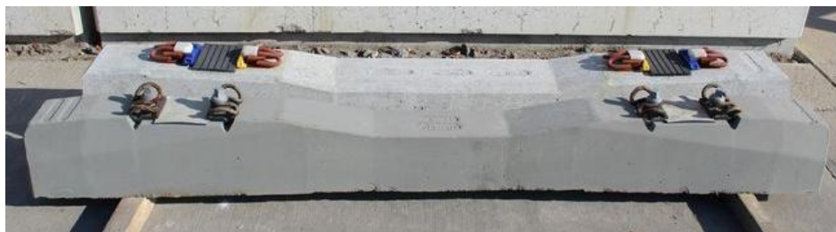
Figuur 8: Dwarsligger in zwavelbeton (vooraan) en in de klassieke betonsamenstelling (achteraan)
